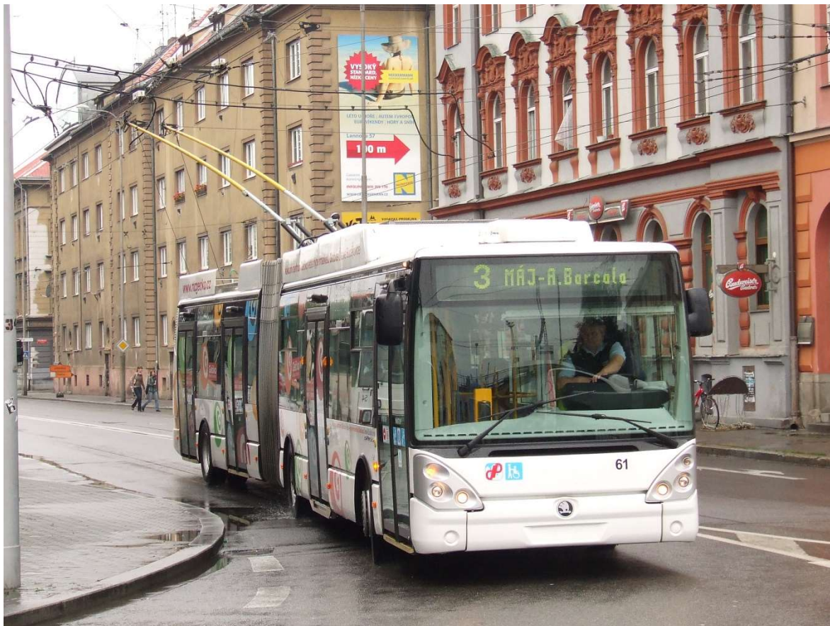
31. ábra: České Budějovice: a 61-es pályaszámú Škoda 25Tr Irisbus 1B (Irisbus Citelis) trolibusz. 2006-os évjáratú, 2025-ben selejtezték. [5]
